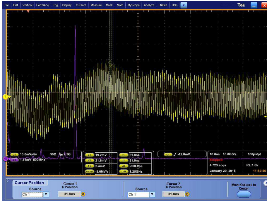
Fig. 1.20 Semnal analizat și afișat în domeniul timp (trasa galbenă) și în domeniul frecvență (trasa violetă)
