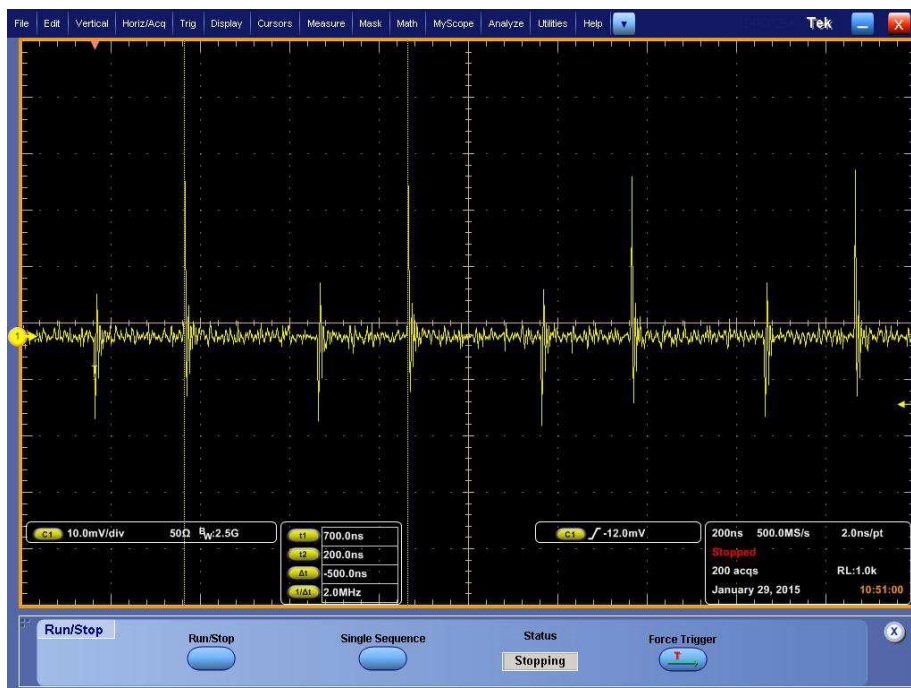
Fig. 1.19 Semnalul captat de o probă tip „buclă” conectată la osciloscopul DPO 7254
